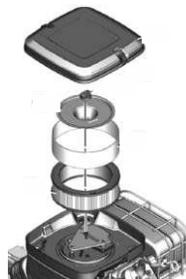
Sie ihn dann mit Druckluft (nicht mehr als 30 psi) aus. Verwenden Sie niemals eine Bürste zur Reinigung, da der Schmutz in das Filterpapier gedrückt wird, anstatt entfernt zu werden, oder die Beschichtung des Papiers beschädigt wird. Wenn die Reinigung erfolglos ist, sollte die Filterpatrone sofort ausgetauscht werden.
