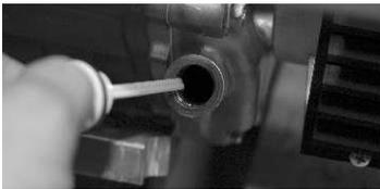
Abb .1 Ölstandskontrolle bei einem Einzylindermotor Honda, Mitsubishi, Rato
